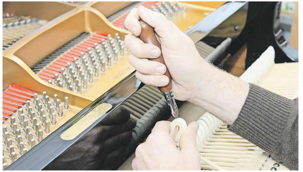
Bei der Intonation wird unter anderem der Filz auf den Hammerköpfen durch Nadeln aufgelockert.
