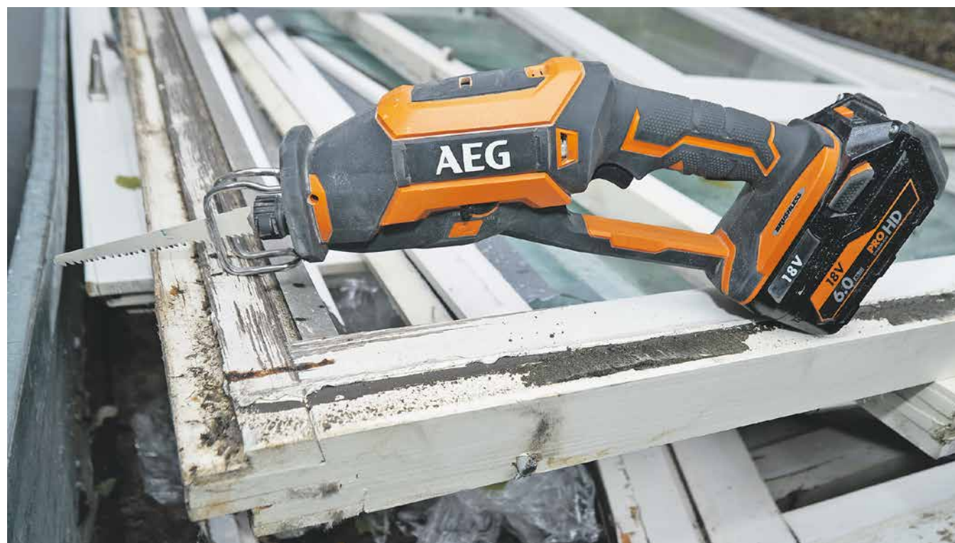
Das Testgerät in seinem Element: Tester Frank Lautenbacher hat die Akku-Säbelsäge AEG BUS 18 CBL im Bereich der Fenstersanierung ausprobiert.
