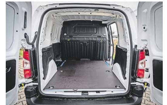
Kubik satt: Bis zu 4 Kubikmeter gehen in die XL-Variante hinein, unser Testmodell in Größe M (also L1) nimmt 3,8 Kubikmeter auf.
