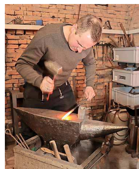
Der Restaurator schmiedet am Amboss aus einem Vierkant-Stab ein Blatt.
