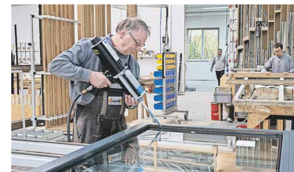
Mit einer Druckluft-Pistole wird der Zwei-Komponenten-Kleb- und Dichtstoff aufgetragen.
