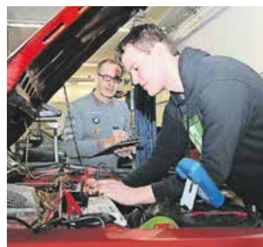
Björn Lübben (19) vom B+K Autohaus in Norden misst die Spannung der Zündspule am Audi 80.
